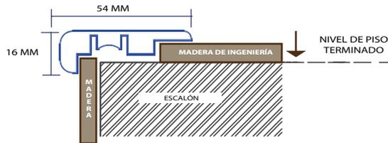
UTILIZADO PARA FINALIZAR ESCALERAS DANDO UN ACABADO CON BOLEO Y SIN BORDES COLOCADO CON CLAVO Y PEGAMENTO.
