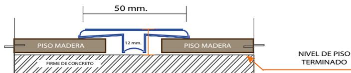
UTILIZADA PARA UNIR DOS PISOS A UN MISMO NIVEL COLOCADO CON CLAVO Y TAQUETE
