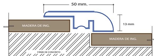
UTILIZADA PARA UNIR PISO DE MADERA CON OTRO PISO DIFERENTE NIVEL COLOCADO CON CLAVO Y TAQUETE
