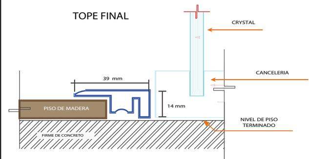
UTILIZADO PARA LOS REMATES DE CANCELERÍA MUEBLES FIJOS VITRALES Y RIELES DE CLÓSETS COLOCANDO CON CLAVO Y TAQUETE.
