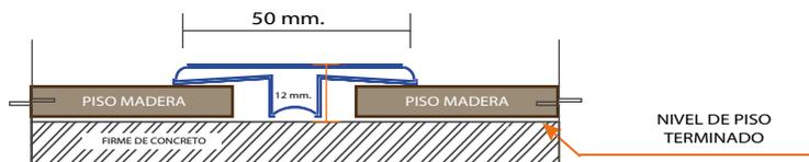
UTILIZADA PARA UNIR DOS PISOS A UN MISMO NIVEL COLOCADO CON CLAVO Y TAQUETE
