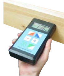
Higrómetro de puntas para madera
