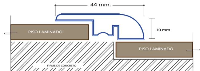
UTILIZADA PARA UNIR PISO LAMINADO CON OTRO PISO A DIFERENTE NIVEL COLOCADO CON CLAVO Y TAQUETE
